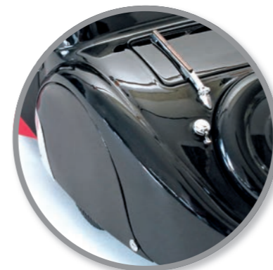
Die Radabdeckungen halten aufgrund der Magnetisierung im Bereich der Kotflügel
